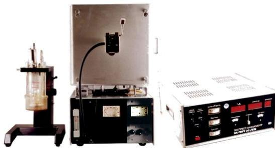
Экспресс-анализатор на серу АС-7932М предназначен для определения массовой доли серы в сталях, сплавах и других материалах методом автоматического кулонометрического титрования по величине рН, для маркировочных анализов и экспрессов-анализов на серу продукции и сырья металлургических и металлообрабатывающих предприятий.
