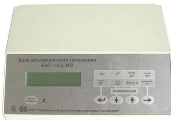
**Блок автоматического титрования БАТ-15.2МП (микропроцессорный) современный последователь БАТ-15.2.**
