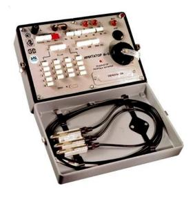
Имитатор электродной системы И-02 предназначен для проверки работоспособности, рН-метров, редоксметров и рХ-метров (иономеров).
