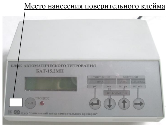
Рисунок 1 - Общий вид блока автоматического титрования БАТ-2МП
