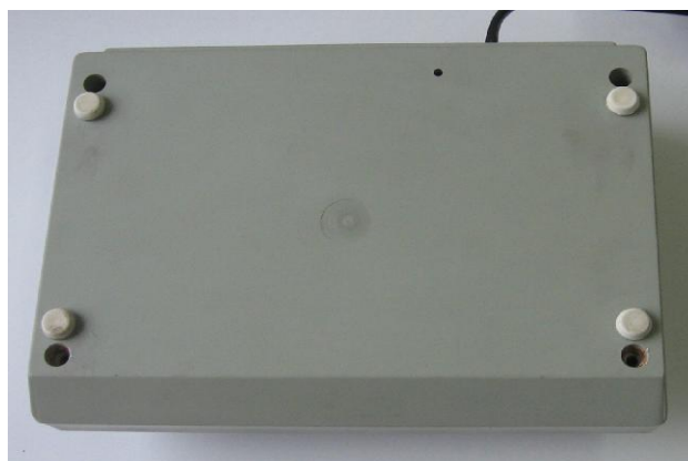
Рисунок 2 - Схема пломбирования прибора от несанкционированного доступа
