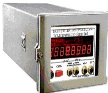
Концентратомер кондуктометрический КП-203 предназначен для измерения концентрации водных растворов солей NaCl, KCl, и удельной электрической проводимости (далее — УЭП) кислот, солей, щелочей и коагулянтов, а также для измерения температуры анализируемой среды
