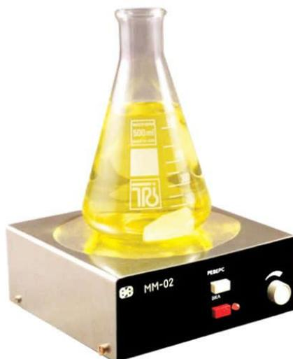
Мешалка с уникальным тихоходным шаговым двигателем, построенным на базе генератора вращающегося магнитного поля.
