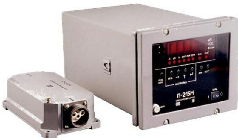
Преобразователи промышленные П-210, П-215М, П-215И предназначены для преобразования ЭДС электродной системы в электрический аналоговый сигнал постоянного тока и напряжения при измерении рН, рХ и редокспотенциала в технологических водных растворах и пульпах, в системах автоматического контроля и регулирования технологических процессов.
