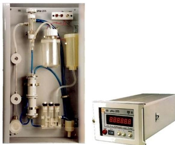
Анализатор иономерный рNa-205 предназначен для автоматического непрерывного измерения активности и концентрации ионов натрия, ЭДС электродной системы и температуры контролируемой среды в питательной и химически обессоленной воде и конденсате пара котлов высокого давления и турбин, а также в системах химического контроля состояния Н<sup>+</sup>-катионитовых фильтров в установках ионообменной очистки природных и сточных вод.
