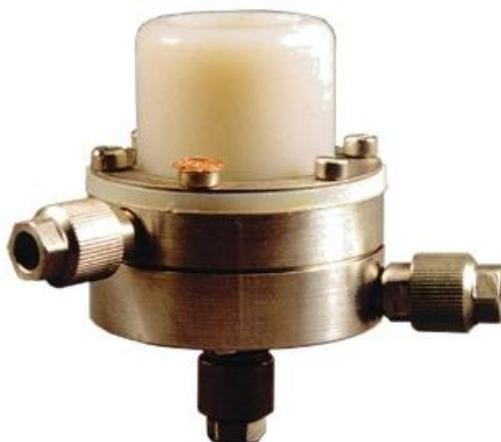
Регулятор давления следящего действия РДС-1 предназначен для автоматического поддержания заданной величины избыточного давления жидкости или газа на выходе регулятора относительно изменяющегося их давления на его входе. При работе в комплекте с арматурой ДПг-4М и ДМ-5М обеспечивает функционирование вспомогательного проточного электрода.
