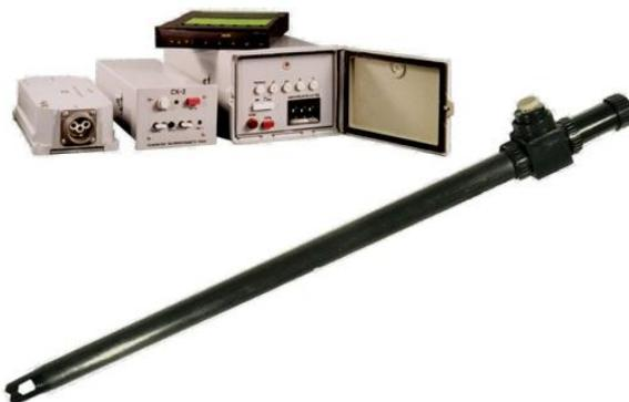
Сигнализаторы наличия в сточных водах хроматов СХ-2 и цианидов СЦ-2 предназначены для сигнализации о превышении концентрации шестивалентного хрома и цианидов от установленной нормы в системах автоматического регулирования на установках очистки сточных вод.
