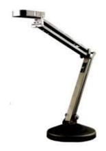
Штатив лабораторный ШЛ-96 предназначены для установки и крепления ионометрических, измерительных и вспомогательных электродов, автоматических термокомпенсаторов и термометров.
