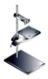
Штатив лабораторный ШЛ-106 предназначены для установки и крепления ионометрических, измерительных и вспомогательных электродов, автоматических термокомпенсаторов и термометров при проведении анализа растворов.
