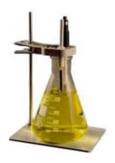
Штативы универсальные ШУ-1, ШУ-2 предназначены для установки и крепления ионометрических, измерительных и вспомогательных электродов, автоматических термокомпенсаторов и термометров (термодатчиков и других устройств при проведении лабораторных анализов растворов.
