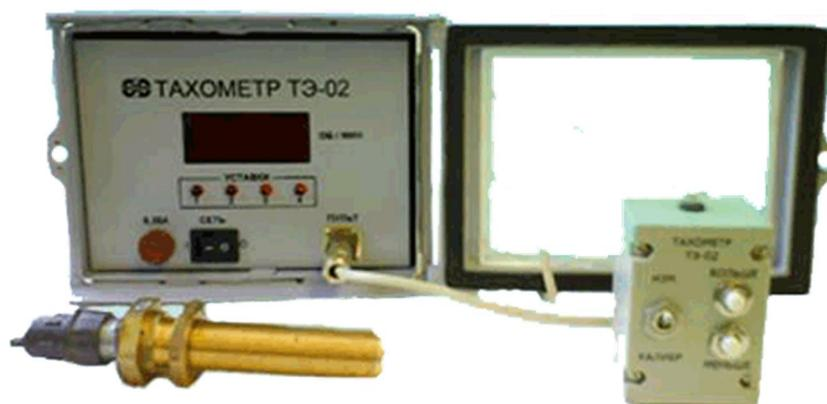
Тахометр предназначен для измерения частоты вращения одно- и многовальных машин и агрегатов. Тахометр выдает информацию о частоте вращения в цифровом виде на блок индикации, формирует токовый сигнал 0...5 мА, пропорциональный частоте вращения, а также обеспечивает выдачу сигналов технологической сигнализации о превышении заданных установок с одновременным включением светодиодов на лицевой панели тахометра.
