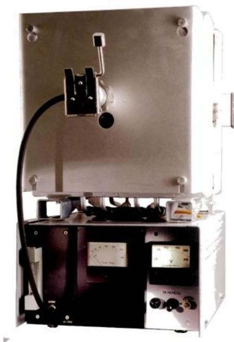
Устройство сжигания УС-7077 предназначено для сжигания проб металлов в потоке кислорода при проведении анализа металла на содержание углерода, серы и других элементов. Конструкция устройства сжигания позволяет обеспечивать низкие тепловые потери.
